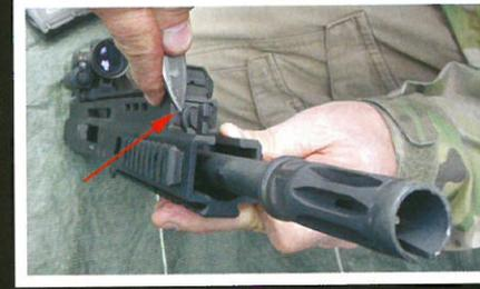
Comprimer l'arrêtoir (flèche) de la commande d'évent des gaz faisant également office de bouchon du tube à gaz.
