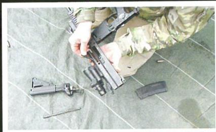
Reculer la culasse en manœuvrant le levier d'armement jusqu'à son cran de démontage, puis le séparer de la culasse.
