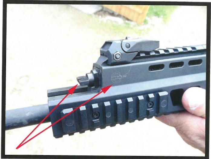
Évent de gaz en position pour le tir de cartouches supersoniques. Le repère HV gravé du côté gauche du boîtier avec le dessin d'un évent en position horizontale permet de lever les doutes éventuels des utilisateurs. Les marquages de l'arme sont réduits au minimum et se limitent aux informations pertinentes en épargnant à l'utilisateur les mentions infantilisantes du style « Keep Out of Reach of the Children » etc.
