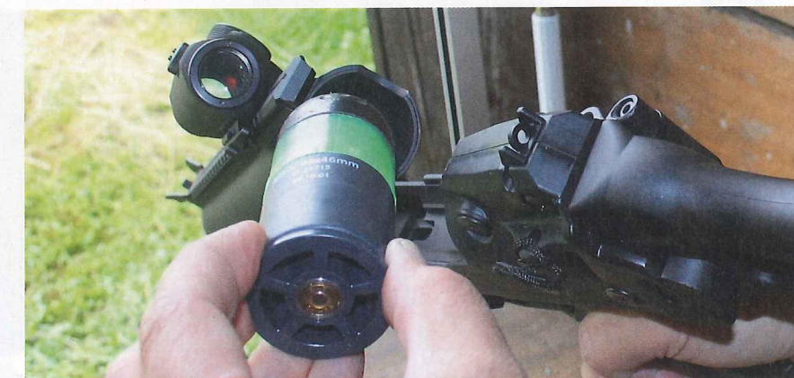
Laden und Entladen: Das Rohr des GL06 besitzt Aussparungen, die das Entnehmen von Patronen oder abgeschossenen Hülsen erleichtern.
