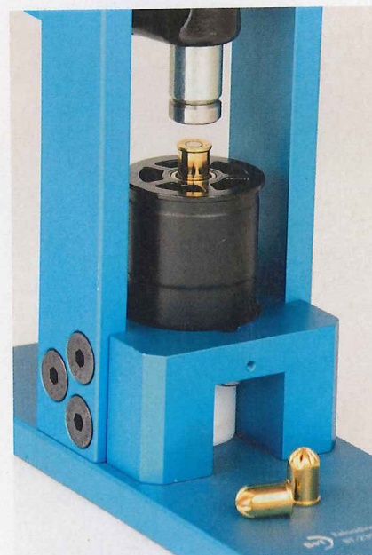
Mit Hilfe dieser Presse lassen sich die abgefeuerten Treibladungskartuschen ausstoßen und gegen neue ersetzen.
