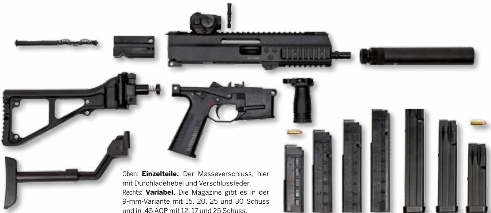
Oben: **Einzelteile.** Der Masseverschluss, hier mit Durchladehebel und Verschlussfeder. Rechts: **Variabel.** Die Magazine gibt es in der 9-mm-Variante mit 15, 20, 25 und 30 Schuss und in .45 ACP mit 12, 17 und 25 Schuss.
