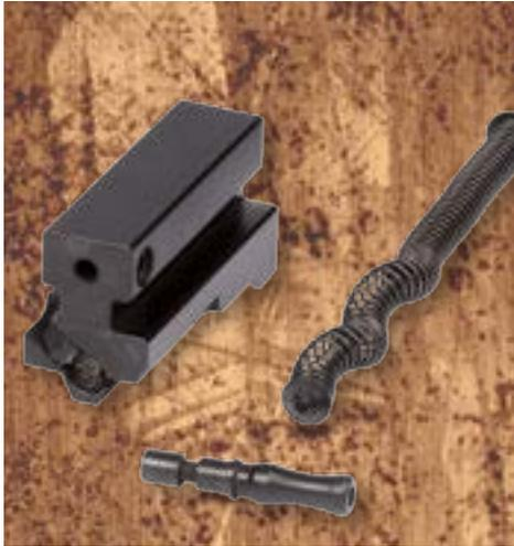
**Leicht.** Der extrem leichte Masseverschluss, mit Durchladehebel und Verschlussfeder.
