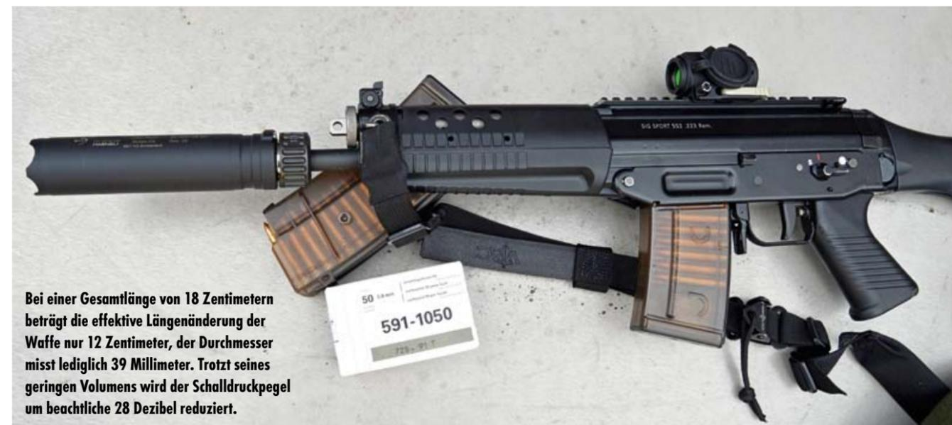
Bei einer Gesamtlänge von 18 Zentimetern beträgt die effektive Längenänderung der Waffe nur 12 Zentimeter, der Durchmesser misst lediglich 39 Millimeter. Trotz seines geringen Volumens wird der Schalldruckpegel um beachtliche 28 Dezibel reduziert.
