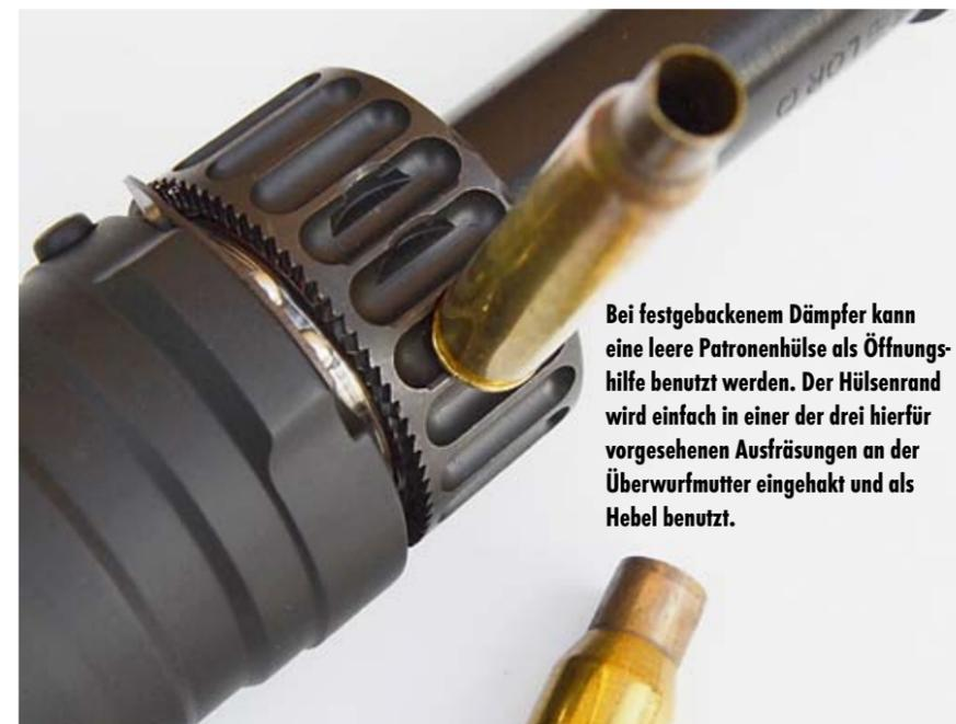
Bei festgebackenem Dämpfer kann eine leere Patronenhülse als Öffnungshilfe benutzt werden. Der Hülsenrand wird einfach in einer der drei hierfür vorgesehenen Ausfräsungen an der Überwurfmutter eingehakt und als Hebel benutzt.
