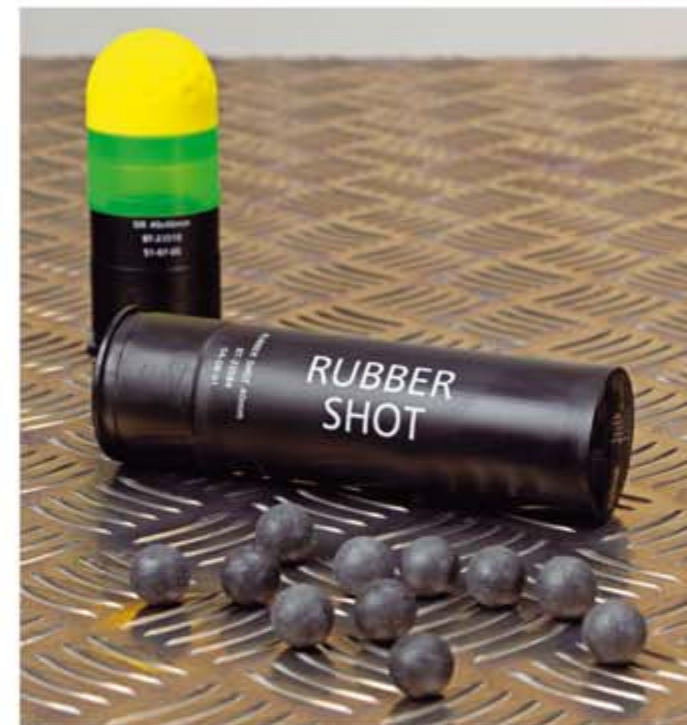
Die Gummischrotpatrone fasst 28 Kugeln à 2,6 Gramm, die zusammen an der Mündung eine Gesamtenergie von 300 Joule erbringen. Dahinter die SIR-Patrone mit dem Wuchtgeschoss (32 Gramm).
