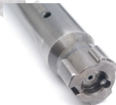
Close-up van de grendelkop. De hulsbodem wordt er helemaal door omsloten. De uitwerper is een pluinjer in de voorkant van de grendelkop.
