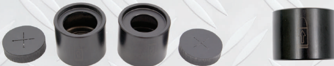
De rubber schijven worden door een rand in de metalen bussen op hun plaats gehouden. De breedte van die rand bleek een flink effect te hebben op de mate van demping. Door hem aan de achterkant breder te maken, en aan de voorkant smaller, werd nog eens een paar dB gewonnen.
