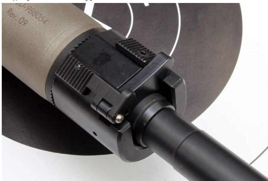
Das Adaptergehäuse mit dem Kupplungsschieber inklusive seiner Sicherung (rechts) sowie die Drehsperrre inklusive deren Sicherung (links)
