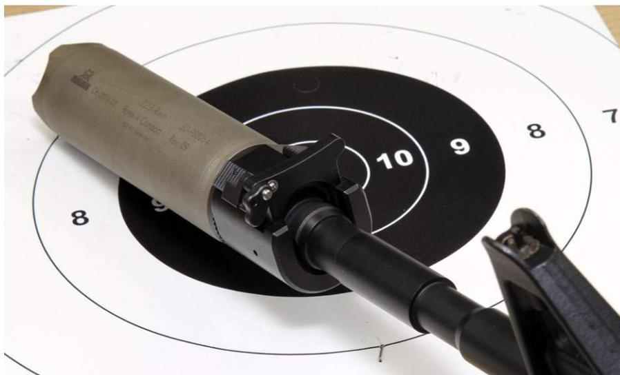
Der Dämpferkörper wird um etwa eine Umdrehung gelöst. Danach wird der Rotex über dem Feuerdämpfer platziert, bis der Kupplungsschieber in die Nut des A2-Dämpfers rutscht
