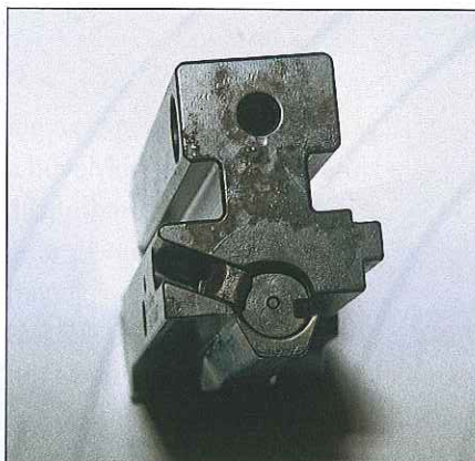
A csőár alatt a kettős adogatópálya külön darab
