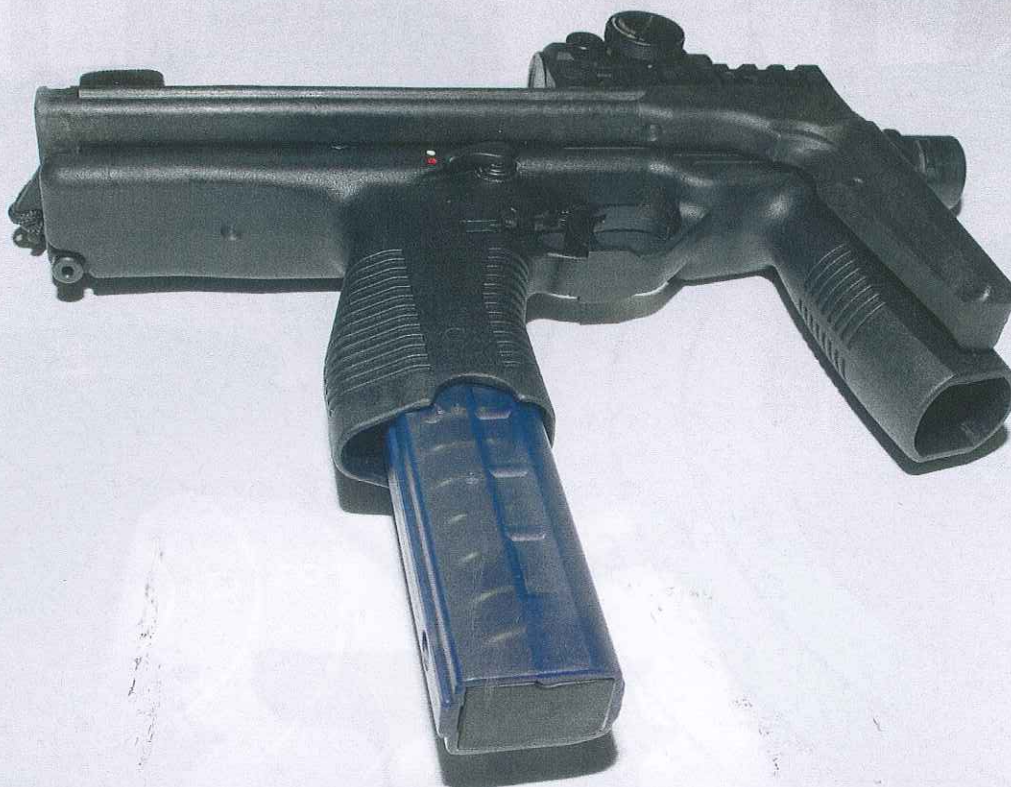
Kétsoros, kétoldali adogatású, műanyag testű tár
