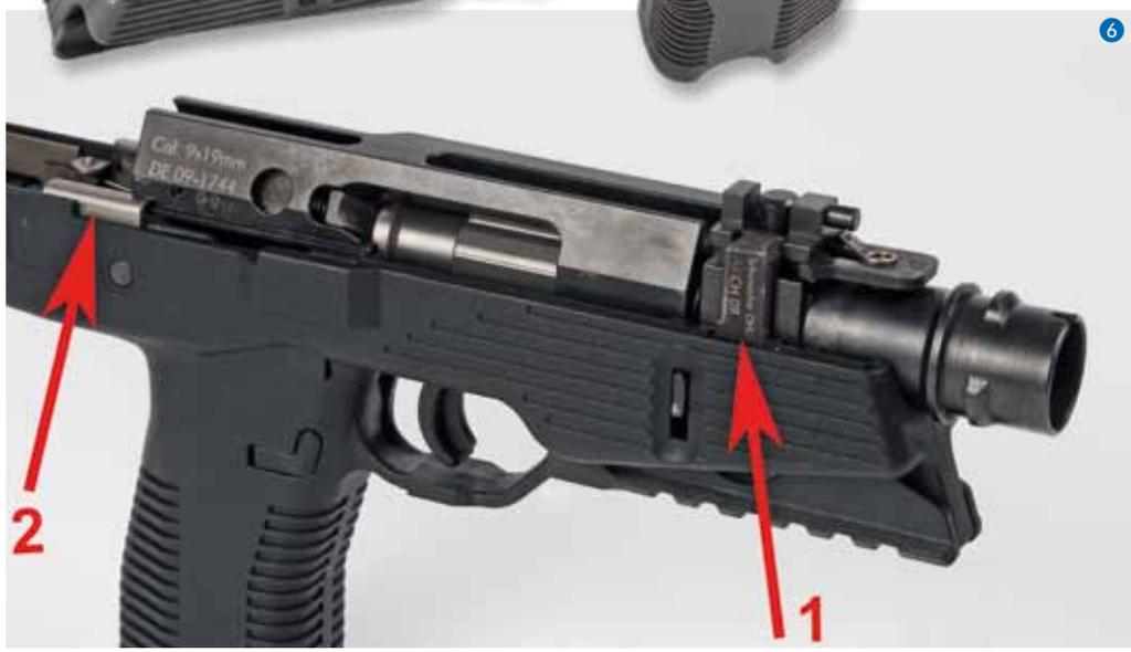
**5 Griffstück.** In das Griffstück der TP9 integriert sind das Abzugssystem sowie die Halterung der Verriegelung und die Verschlussführungen.
