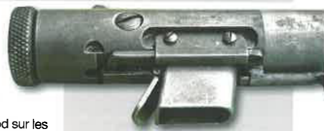
Côté droit d'un Welrod. On retrouve une architecture très proche de celle du VP9, en particulier : le même dispositif de vis de blocage de la culasse.
