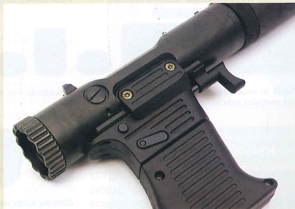
Tylna część VP9 – widoczna śruba ogranicznika skoku zamka i powierzchnia pokrętki zamka
