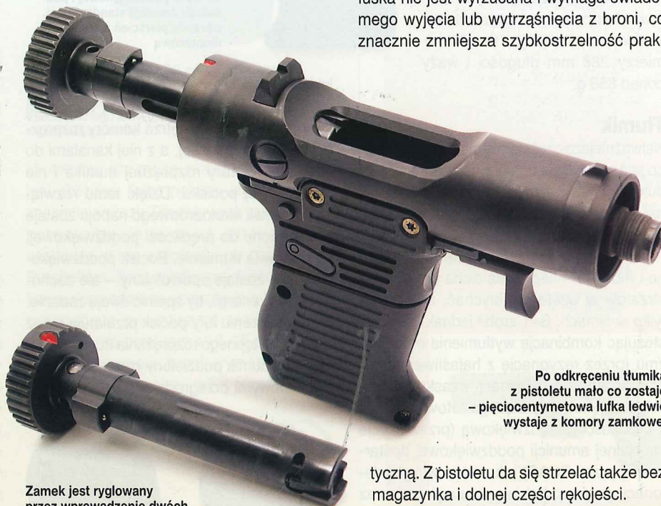
Komora spustowa jest zamocowana do komory zamkowej śrubami. W tylnej części komory spustowej, za logiem producenta i oznaczeniem typu widoczny jest wyłączony (odsłonięty czerwony pasek) bezpiecznik
