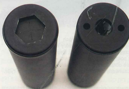
Widok z przodu na wyloty dwóch tłumików. Z lewej sześciokątny otwór na klucz do rozkładania tłumika do amunicji poddźwiękowej, z prawej nierozbieralny wylot tłumika do amunicji standardowej
