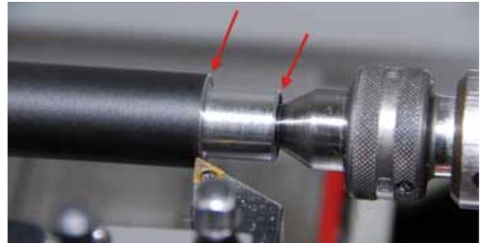
Die beiden Kanten (Lauf – Gewindeteil und Gewindeteil – Mündung) sollten mit einer leichten 45-Grad-Phase gebrochen werden.
