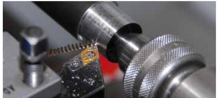
Zunächst in kleineren Schritten bis auf den vorgegebenen Außendurchmesser des Gewindes abdrehen.
