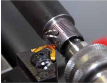
In mehreren Durchgängen und unter Zuhilfenahme von Schneidöl das Gewinde schneiden.
