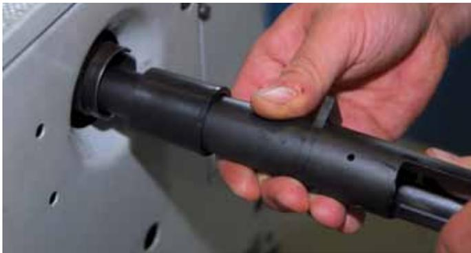
Ein schnell selbstgefertigter Schutzkragen aus Kunststoff schützt den Lauf vor Kontakt mit der Durchführung der Drehbank und so vor Kratzern.
