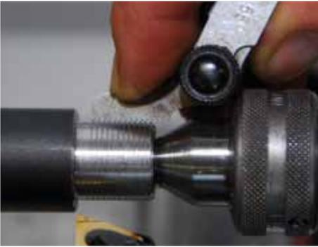
Es empfiehlt sich, das Gewinde im ersten Schritt nur minimal in den Lauf zu ritzen, um mit der Gewindelehre noch einmal zu prüfen, ob die Drehbank richtig eingestellt ist.
