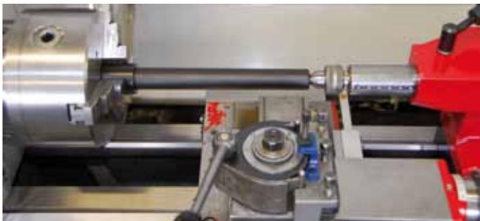
Auch der Lauf sollte mittels eines selbstgefertigten Schutzkragens im Dreibeckenfutter vor Kratzern geschützt werden. Ist der Lauf gespannt, die Mündung mittels einer mitlaufenden Spitze vorsichtig zentrieren.
