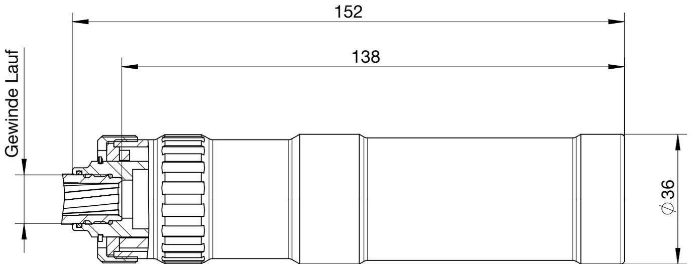
Laufgewinde bei Bestellung spezifizieren
