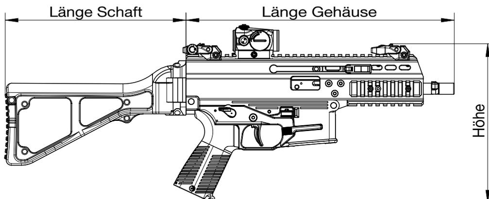
Die jeweilige Gesamtlänge wird mittels Schaftlänge und Gehäuselänge errechnet.
