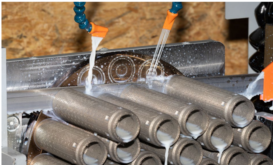
MITTELS EINER BANDSÄGE werden die Schalldämpferkörper von der Grundplatte abgeschnitten.
