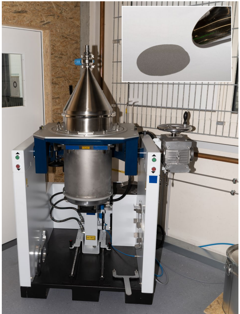
RESTEVERWERTUNG Diese Maschine „schüttelt“ das übrige Metallpulver aus den Dämpfern, sodass es wiederverwertet werden kann.
