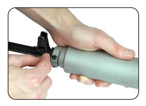
Le réducteur de son doit être fermement fixé sur la bouche et le bouton de la bouche doit s'engager dans la rainure correspondante de l'anneau adaptateur. Sinon, la bague d'adaptation doit être réajustée.
