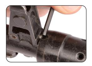
Vissez la bague d'adaptation sur la bouche aussi loin que possible jusqu'à ce que la bouche dépasse de la bague d'adaptation et que le bouton de l'accessoire de la bouche s'enclenche dans la dernière rainure possible.
