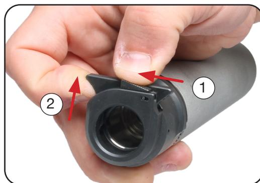
c. Desserrez le corps du silencieux d'environ un tour dans le sens inverse des aiguilles d'une montre. Si le corps du silencieux a déjà été desserré, cette étape peut être passée.
