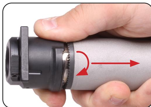
d. Faites coulisser le silencieux sur le cache flamme / compensateur et alignez la glissière parallèlement aux méplats du cache flamme / compensateur.
