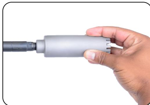
d. Avant de serrer avec la clé dynamométrique, vérifiez que le canon et le silencieux sont correctement alignés.
