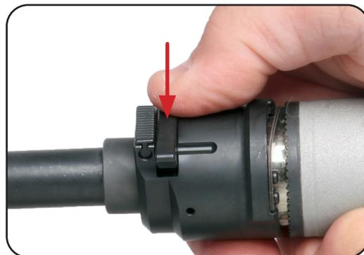
f. Serrez le silencieux dans le sens des aiguilles d'une montre jusqu'à ce qu'il soit fermement verrouillé sur le cache flamme / compensateur.
