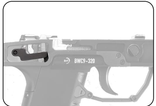
8. Drehen Sie den Haltebolzen während Sie ihn von der linken Seite ins Gehäuse führen und drücken Sie ihn, um ihn an der Haltefeder in der Abzugseinheit vorbeizuschieben.
