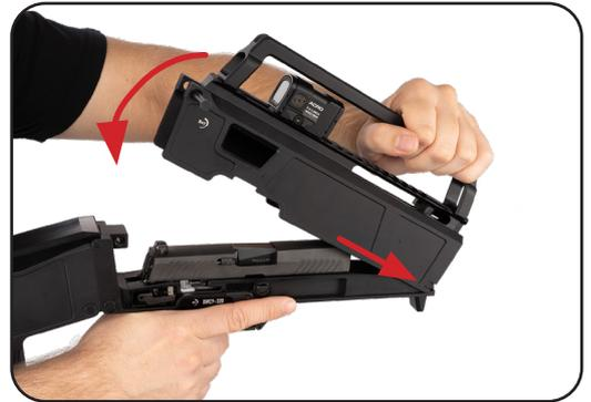
17. Wenn der Deckel vollständig geschlossen ist, drücken Sie den Zerlegebolzen hinein, bis er mit der Seite der oberen Abdeckung bündig ist.
