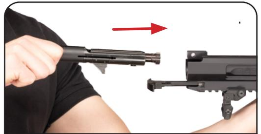
f. Die Verschlussführung muss mit der Führung im Ladehebel deckungsgleich sein.
