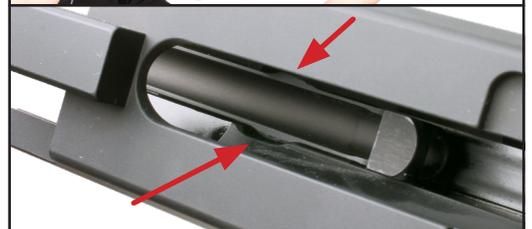
j. Danach den Ladehebel nach unten drücken und aus dem Gehäuse herausziehen.
