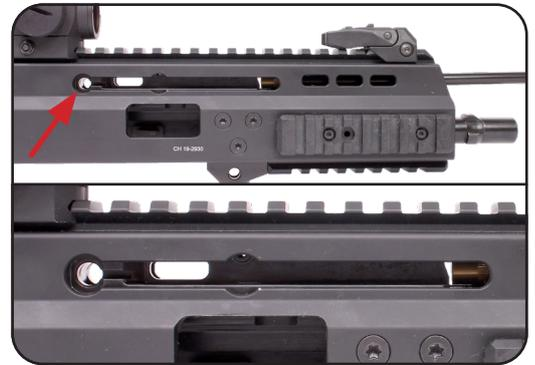
c. Insérez le levier d'armement dans le bon sens, pour que la goupille s'insère dans le support du levier d'armement.
