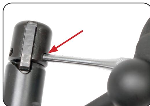
b. Pour armer le ressort de la goupille de percuteur, tournez le tournevis dans le sens des aiguilles d'une montre dans la serrure jusqu'à ce que la goupille de percuteur atteigne sa position finale.
