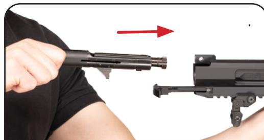
f. Le guide de verrouillage doit être aligné avec le rail du levier de chargement.
