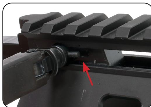
d. Poussez le levier d'armement en place. Le levier d'armement peut être monté des deux côtés, en fonction de la préférence de l'utilisateur.
