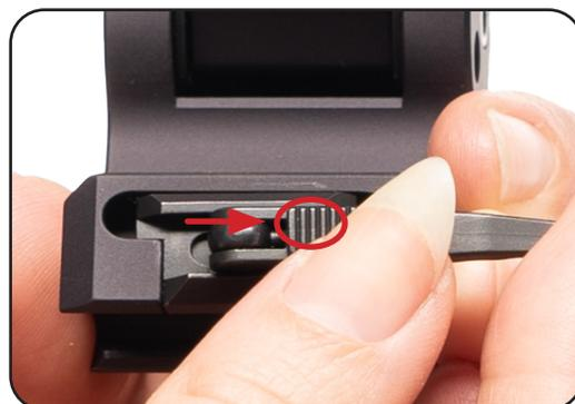
b. Placez l'ensemble sur le rail d'accessoires avec le renforcement en V.
